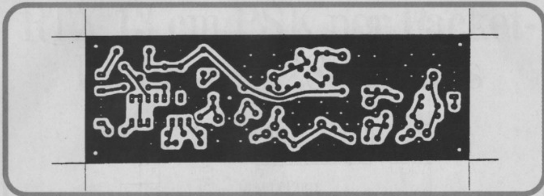
18 Circuito stampato della media frequenza 75/10 MHz (FR4 monofaccia 1.6 mm).
