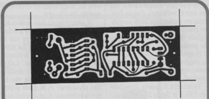
⊗ Circuito stampato della commutazione RX/TX (FR4 monofaccia 1,6 mm).
